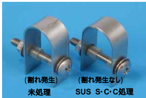
図1 応力腐食割れ試験片の外観
